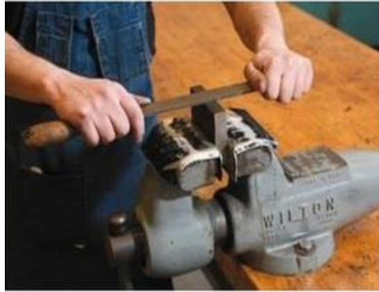
شكل رقم ٩١: الطريقة الصحيحة للضغط بالمبرد على قطعة الشغل.
