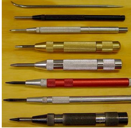
شكل رقم ٢٦: يوضح الأنواع المختلفة من شوك العلام
