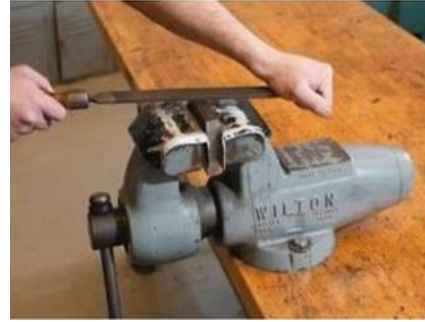
شكل رقم ٩٠: الطريقة الصحيحة للإمساك بالمبرد أثناء عمل برادة للأسطح.
