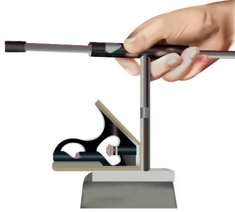
شكل رقم ١٢٨: ضبط تعامد ذكر القلاووظ
