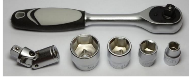
شكل رقم ٢٠: مفاتيح سقاطة و طقم لقم Hexagonal
