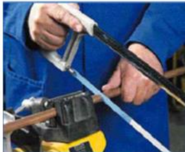
شكل رقم ١٣٦: قطع الماسورة بالمقاس المناسب
