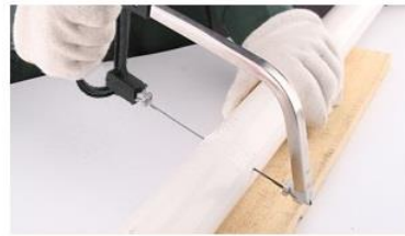
شكل رقم ٣٨: عملية نشر قطع مختلفة باستخدام منشار التخريم اليدوي
