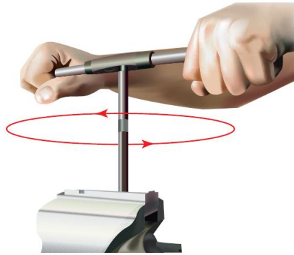
شكل رقم ١٣٠: لف البوجي للاتجاه المعاكس بمقدار نصف لفة
