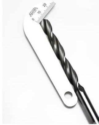
شكل رقم ١٠٨: فحص زاوية رأس البنطة بالمنقلة ومحدد المتقاب
