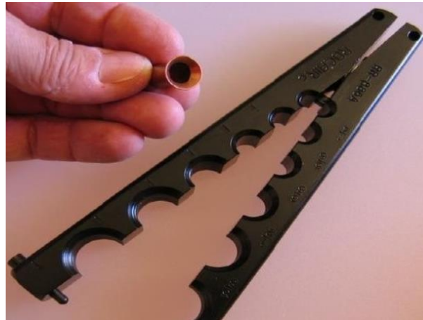
شكل رقم ١٣٩: النتيجة النهائية بعد عمل الفلير
