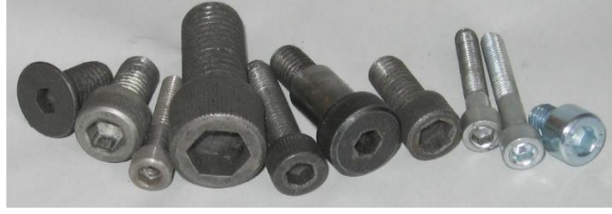
شكل رقم ١٩: مسامير برأس سداسي Hexagonal
