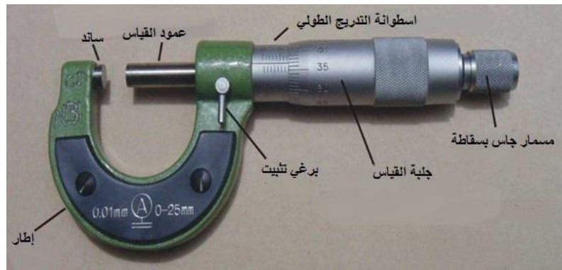
شكل رقم ٣٤: المكونات الرئيسية للميكرومتر.
