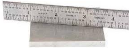
شكل رقم ١٠٠: قياس استوائية السطح باستخدام حافة المسطرة
