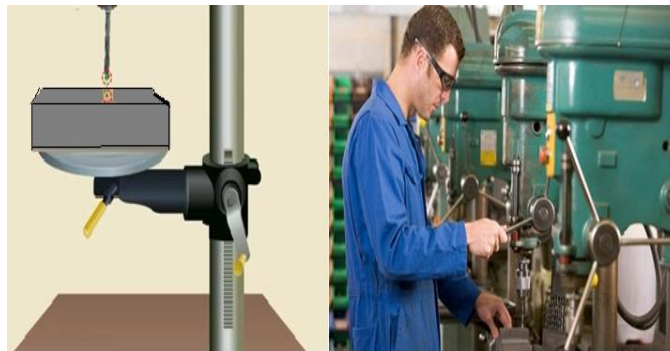
شكل رقم ١١٠: التأكد من مركزية البنطة مع مركز الثقب المطلوب
